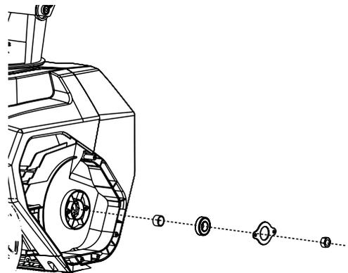
10. Vuelva a instalar la placa lateral izquierda (26), la polea grande (23), la correa (22) y la cubierta lateral izquierda (25).
