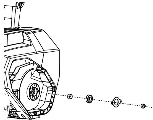
10. Réinstallez la plaque latérale gauche (26), la grande poulie (23), la courroie (22) et le couvercle latéral gauche (25).
