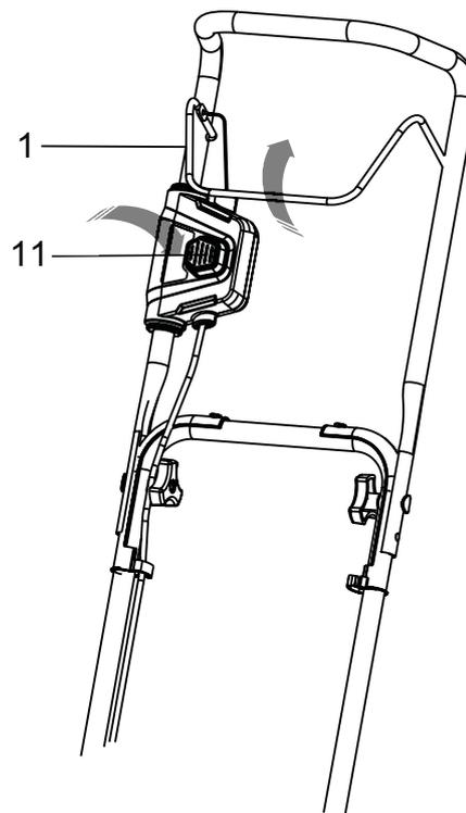
1. Mientras mantiene presionado el botón del interruptor de seguridad (11), tire de la palanca de seguridad (1) para arrancar la máquina.
