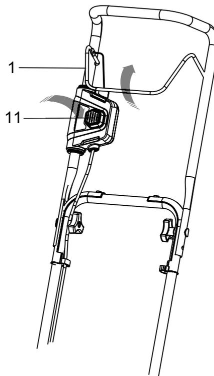
1. Tout en maintenant le bouton de l'interrupteur de sécurité enfoncé (11), tirez sur le levier de verrouillage (1) pour démarrer la machine.
