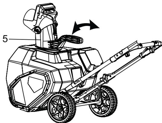
Puede ajustar el conducto de descarga 180° para cambiar la dirección de la nieve.
