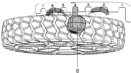
1. Tirez le levier de réglage de la hauteur (8) vers l'arrière pour augmenter la hauteur de la lame.
