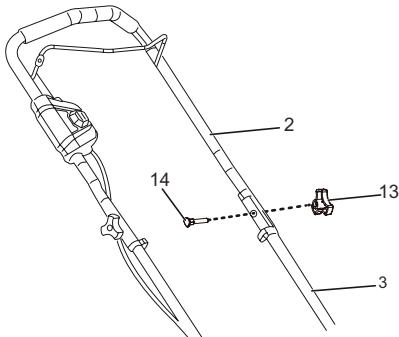
1. Alinee los orificios del asa superior (2) y el asa inferior (3).
