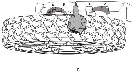
1. Tire hacia atrás de la palanca de ajuste de altura (8) para aumentar la altura de la cuchilla.
