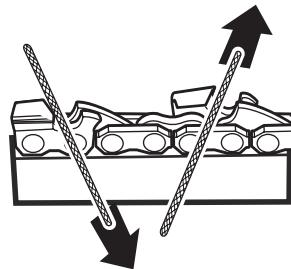
3. Affûtez la plaque supérieure, la plaque latérale et la jauge de profondeur avec une lime plate.
