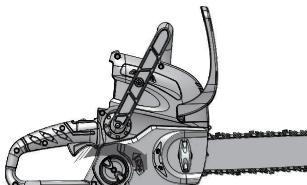
5. Lorsque la chaîne est à la tension voulue, serrez le couvre-chaîne.
