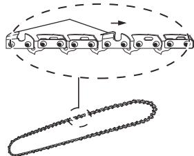
5. Coloque la cadena en su posición y asegúrese de que el bucle esté detrás de la barra de guía.
