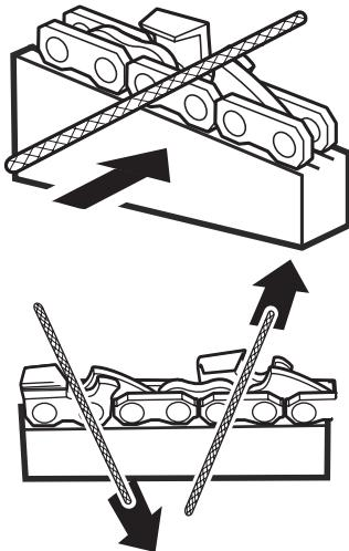
3. Afile la placa superior, la placa lateral y el calibrador de profundidad con una lima plana.
