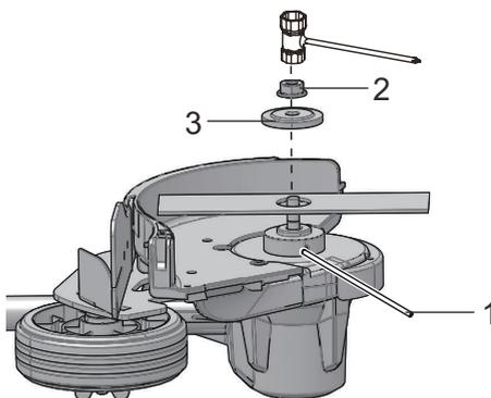
4. Retire la cuchilla usada y sustitúyala por una nueva.
