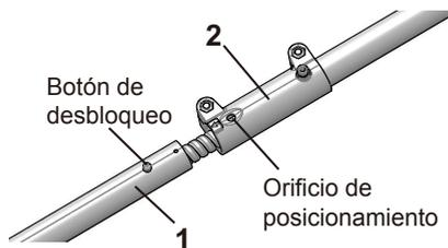
4. Gire el eje inferior hasta que el botón se bloquee en el orificio de posicionamiento.
