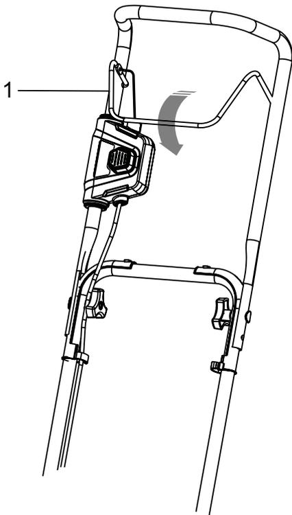
1. Suelte la palanca de seguridad (1) para detener la máquina.
