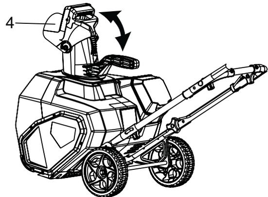
Puede ajustar el deflector del conducto hacia arriba y abajo para cambiar la distancia de lanzamiento de la nieve.
