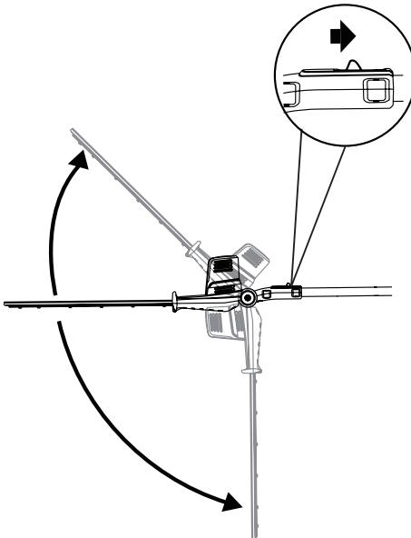
El cabezal de corte puede bloquearse en 7 posiciones.
