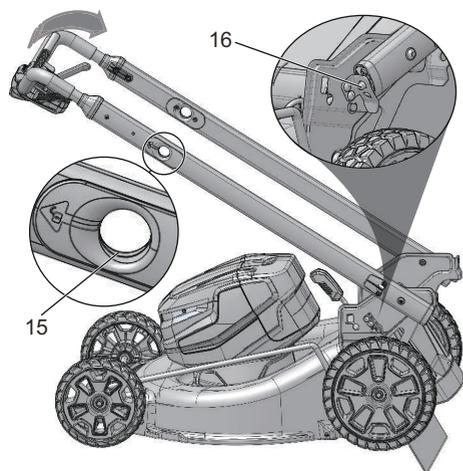
1. Tire hacia arriba sobre los orificios del asa (15) para desbloquear las asas inferiores.
