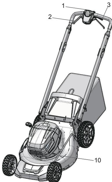
1. Cuando el cortacésped esté listo para la puesta en marcha, puede agarrar el asa de puesta en marcha (2) o la palanca de autopropulsión (3) para encender la luz delantera LED (10).
