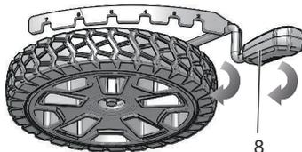
1. Tire hacia atrás de la palanca de ajuste de altura (8) para aumentar la altura de corte.
